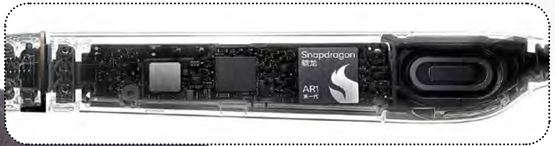
Las Xiaomi AI Glasses incorporan el chipset AR1 Gen 1 de Qualcomm, desarrollado específicamente para gafas inteligentes, junto con 4 GB de memoria RAM.
