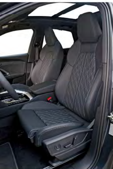
Butacas delanteras eléctricas, calefactables y ventiladas; detrás la banqueta desliza por secciones. El maletero queda en 433 litros por la batería PHEV.
