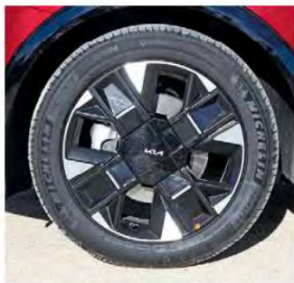
Nuevas llantas de aleación de 19" con neumáticos 235/50, de serie firmados por Michelin.
