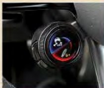
Este mando del volante ajusta la dureza de la suspensión...
