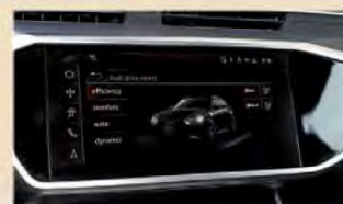
Desde la pantalla táctil se elige el perfil de conducción. Admite memorizar dos ajustes.
