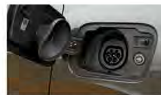
En tomas de corriente alterna de 11 kW llena batería en 2,5 horas. No contempla carga CC.
