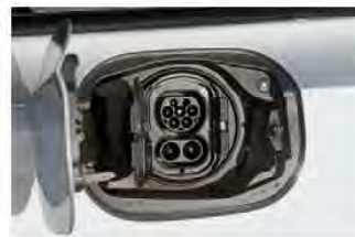
En dos horas y media la batería carga en una toma de 11 kW; y en 20 minutos en CC a 60.
