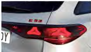
Faros DIGITAL LIGHT: adaptan la iluminación a las condiciones de la calzada y del tráfico.
