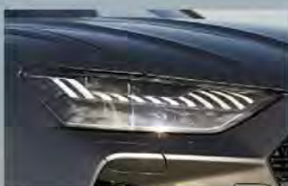
Faros LED Matrix HD con luz láser e intermitentes dinámicos de serie, una filigrana.
