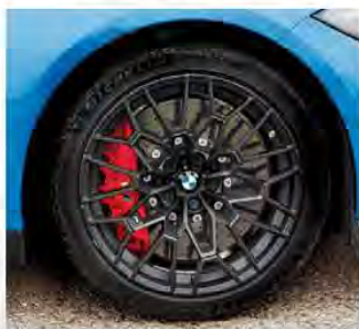
La frenada corre a cargo de un sistema M Compound. En opción ¡ajo! hay frenos carbocerámicos.
