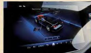
El motor eléctrico va integrado dentro del cambio automático 9G-TRONIC.
