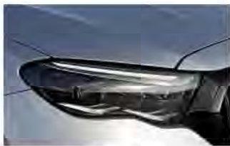
Faros DIGITAL LIGHT: adaptan la iluminación a las condiciones de la calzada y del tráfico.
