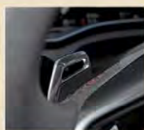
Levas en el volante para gestionar el cambio Tiptronic.
