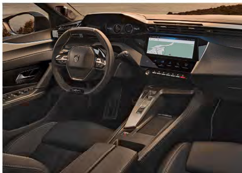
Puesto de mando i-Cockpit, con volante pequeño e instrumentación digital por encima. El equipo de infoentretenimiento varía según acabados: iConnect para el Allure e i-Connect Advanced en el resto.
