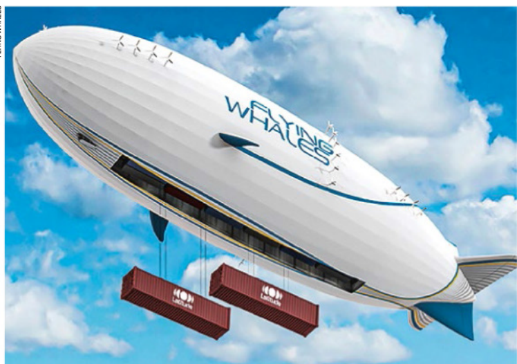
Recreación del dirigible francés del LCA60T y de su sistema de izado de carga mediante eslingas.
