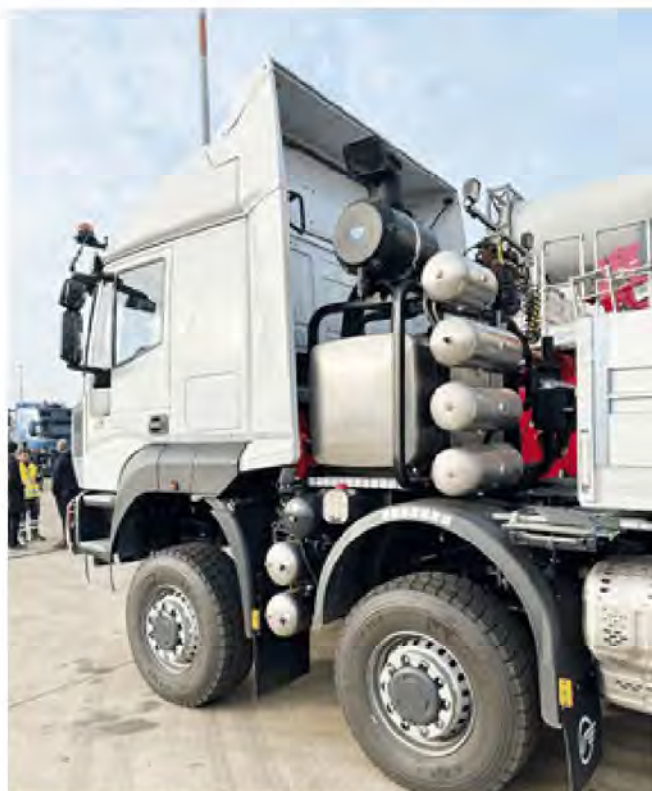
Sistema de refrigeración y depósitos auxiliares situados tras la cabina
